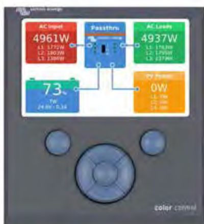
Color Control Panel, mit Anzeige eines PV-Systems
