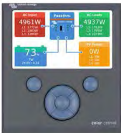
Color Control Panel, mit Anzeige eines PV-Systems
