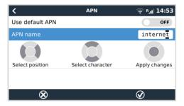
5. Wenn Sie das GX LTE 4G in einem Gebiet installieren, in dem mit gelegentlichen Störungen der Internetabdeckung zu rechnen ist, sollten Sie die Option "Reboot device when no contact" (Gerät neu starten, wenn kein Kontakt besteht) im VRM-Menü des GX-Geräts aktivieren. Dadurch wird das GX-Gerät automatisch neu gestartet und das GX wird ausgeschaltet, wenn es für die konfigurierte Zeit keine Daten an VRM übertragen hat.
