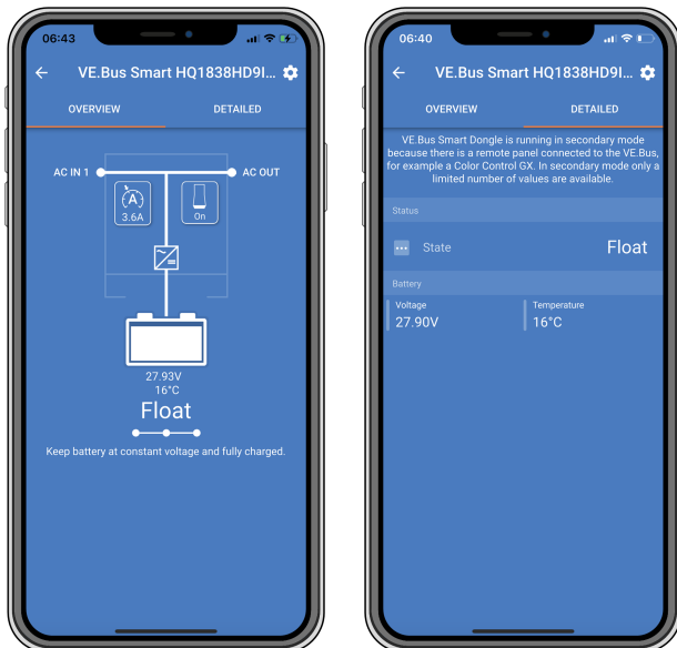
Écrans VictronConnect lorsque la clé électronique est connectée à un dispositif GX.
