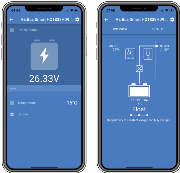
Écrans VictronConnect sans et avec un convertisseur/chargeur connecté.
