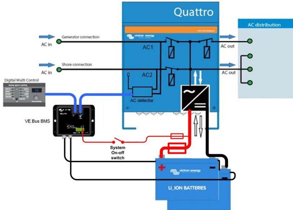
Afbeelding 1: Blokschema met AC Detector in een Quattro
