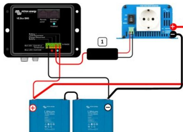
**Belastingsontkoppelingsschakelaar, waarvoor een niet-omvormende kabel voor het op afstand in- of uitschakelen is vereist (artikelnummer ASS030550200)**
