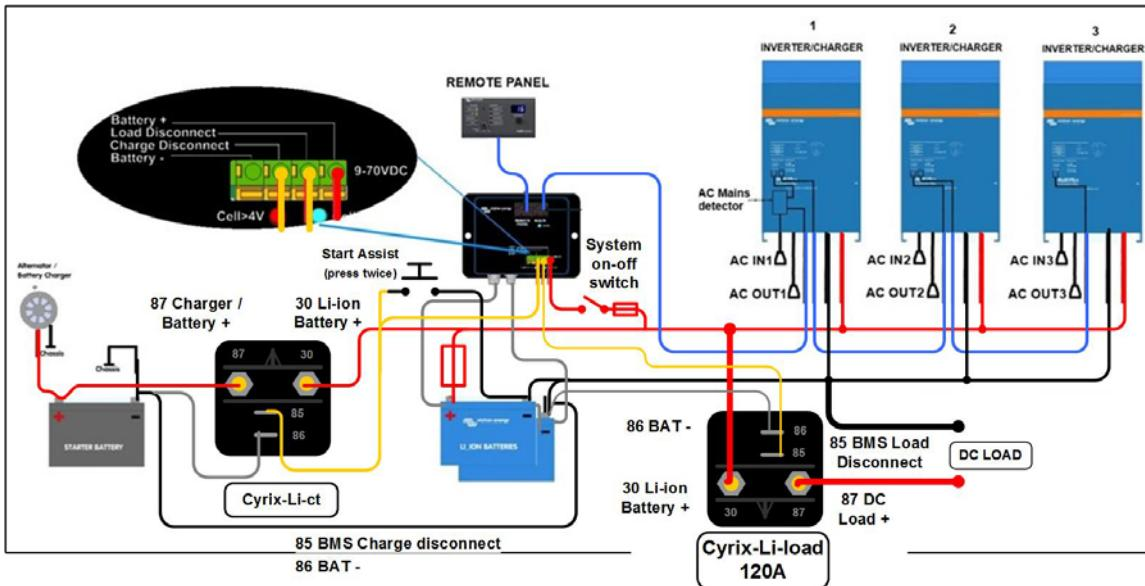
Abbildung 8: Systembeispiel für ein Boot oder Fahrzeug mit einer Drei-Phasen-Konfiguration des Wechselrichter/Ladegeräts (DC-Sicherung nicht angezeigt, nur die Lithium-Ionen-Batterie-Sicherung).
