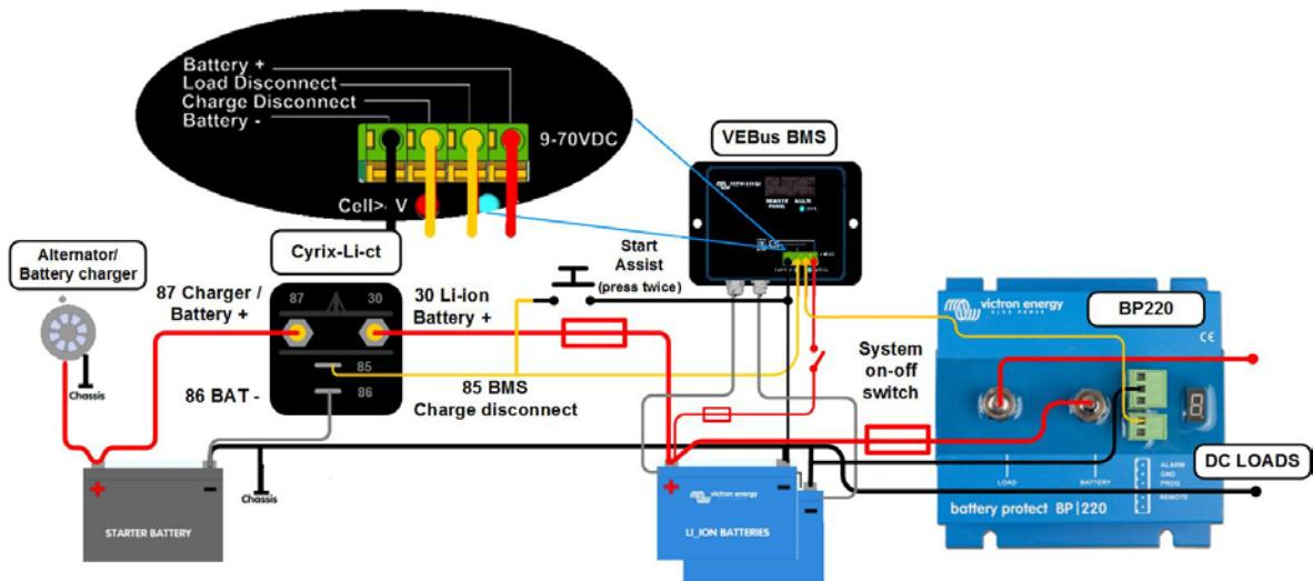
Abbildung 6: Ein reines DC-System für ein Boot oder Fahrzeug mit Parallel-Anschluss der Starter- und Lithium-Ionen-Batterie
