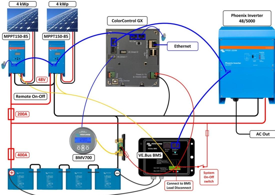
Abbildung 11: Solaranlage mit zwei MPPT 150/85.
