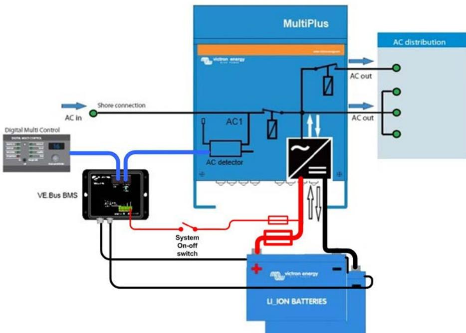
Afbeelding 2: Blokschema met AC Detector in een MultiPlus
