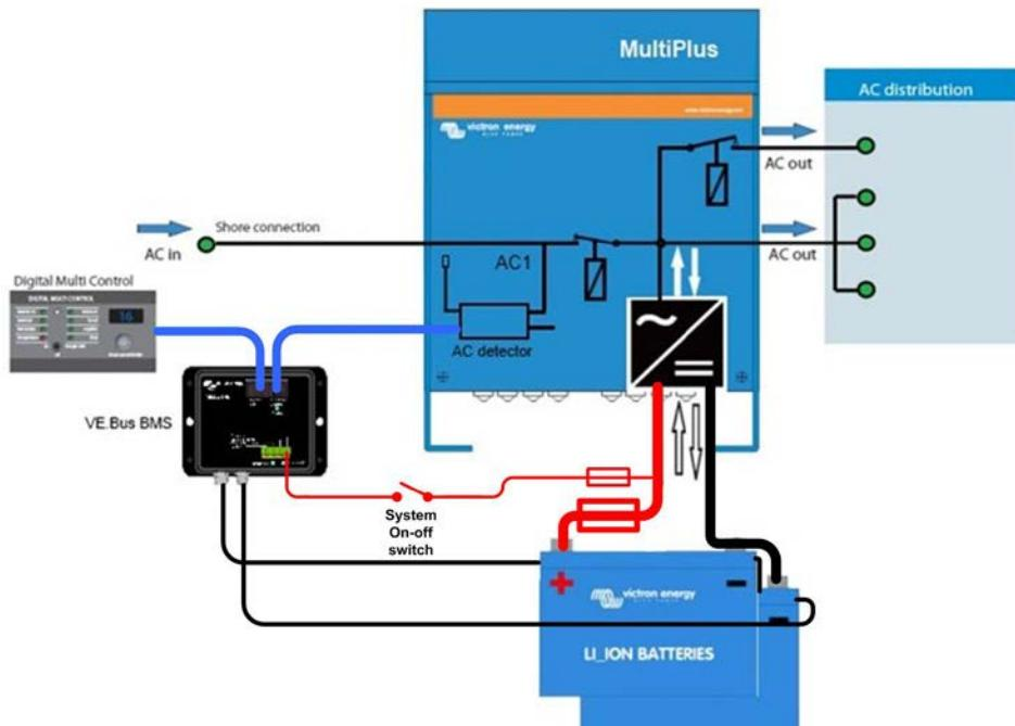
Abbildung 2: Blockdiagramm mit einem AC Detector in einem MultiPlus
