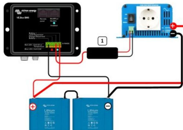
Interruptor de desconexión de carga para el que se necesita un cable on/off remoto no inversor
