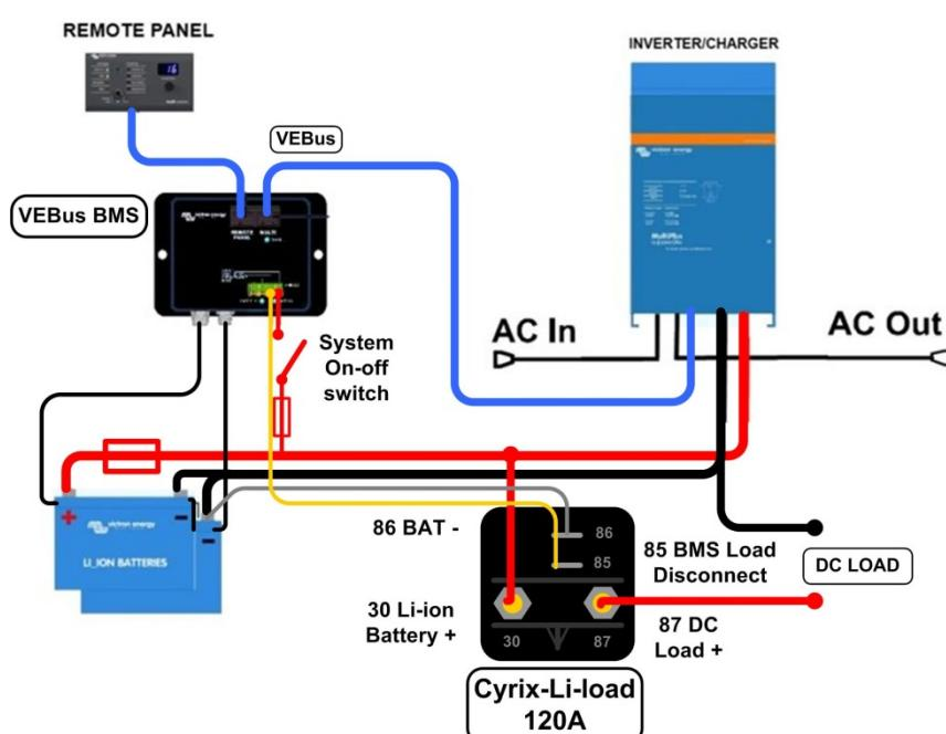
Figura 5: Sistema con MultiPlus y cargas de CC
