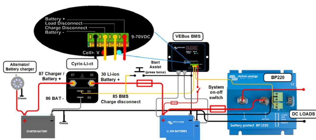
Afbeelding 6: DC-systeem voor een boot of voertuig met parallele aansluiting van de start- en lithium-ion-accu
