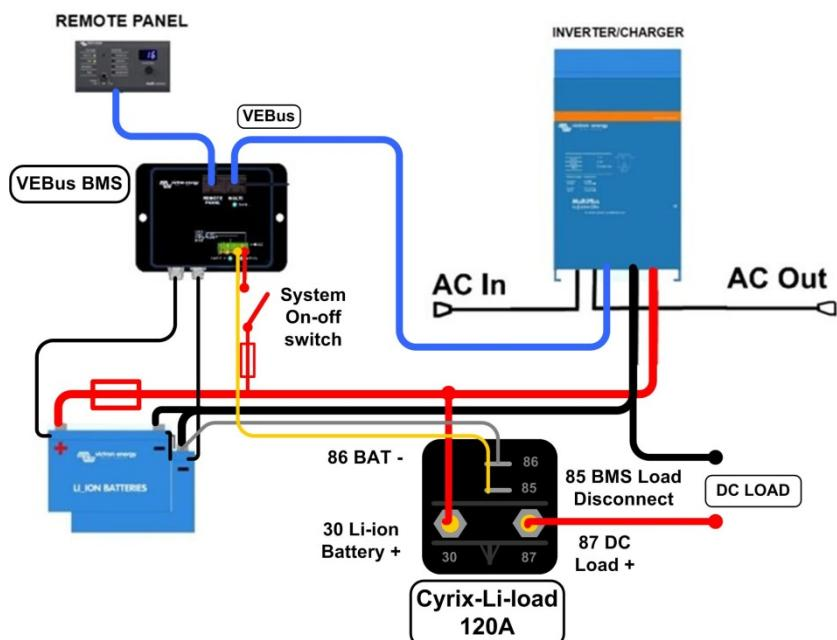
Abbildung 5: System mit MultiPlus und DC-Lasten
