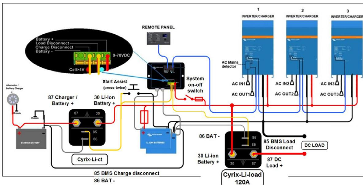
Figura 8: Ejemplo de sistema para una embarcación o vehículo con una configuración trifásica del inversor/cargador (no se muestran los fusibles CC , a excepción del fusible de la batería Li-ion)
