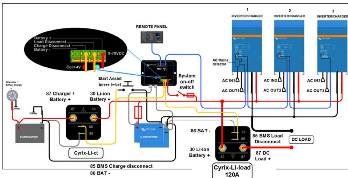
Afbeelding 8: Systeemvoordeel voor een boot of voertuig met een driefase-omvormer-/laderconfiguratie (DC-zekeringen niet weergegeven, alleen de lithium-ion-accuzekering)
