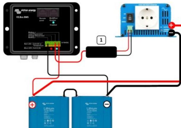
Schalter zum Trennen der Last für den ein nicht invertierendes Kable zum ferngesteuerten Ein-/Ausschalten benötigt wird
