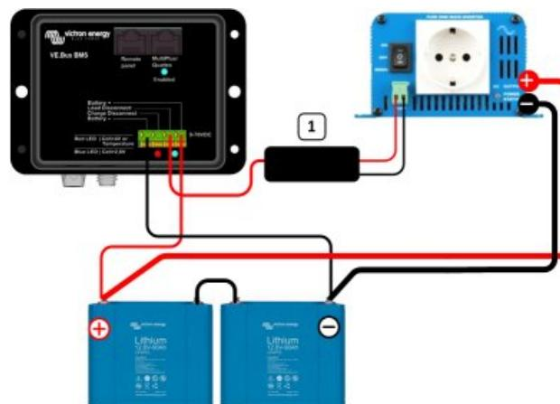
Interrupteur de déconnexion de charge pour lequel un câble non inverseur d'allumage/arrêt à distance est nécessaire
