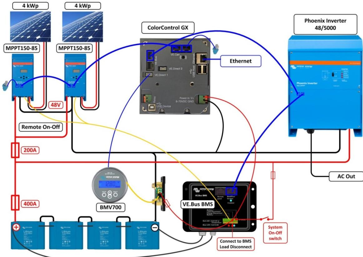
Figura 11: Aplicación solar con dos MPPT 150/85
