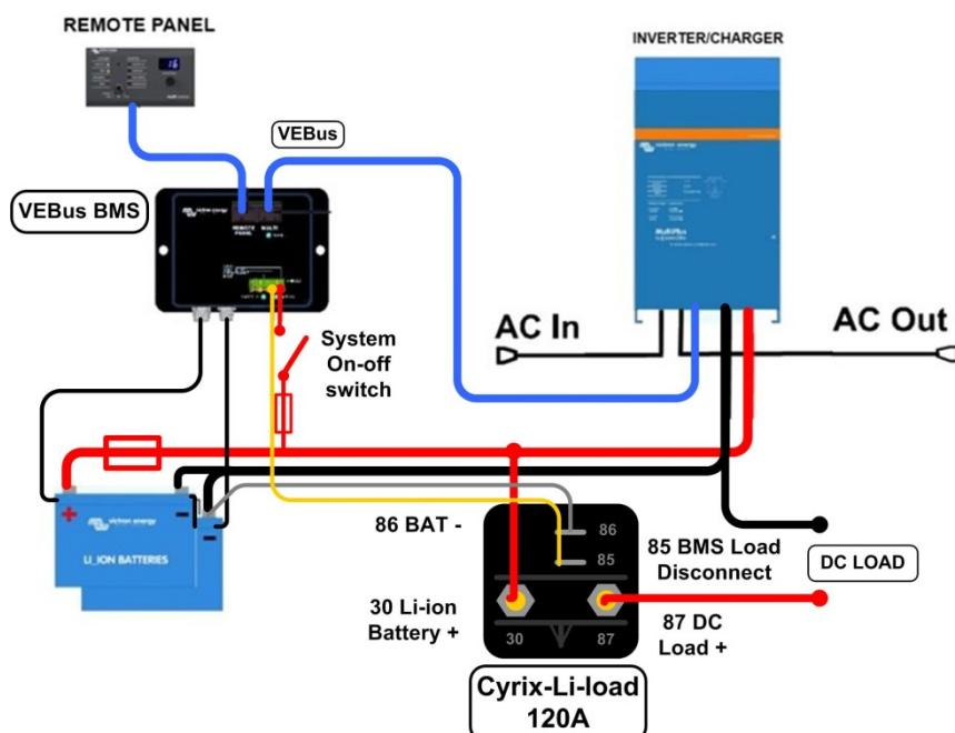
Schéma 5 : Système avec MultiPlus et charges CC
