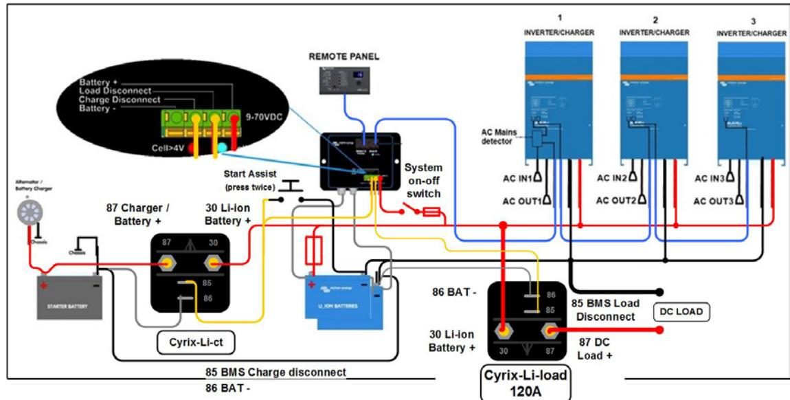
Schéma 8 : Exemple de système pour un bateau ou un véhicule avec un convertisseur/chargeur en configuration triphasée (fusibles CC non montrés, saut pour le fusible de la batterie au lithium-ion).
