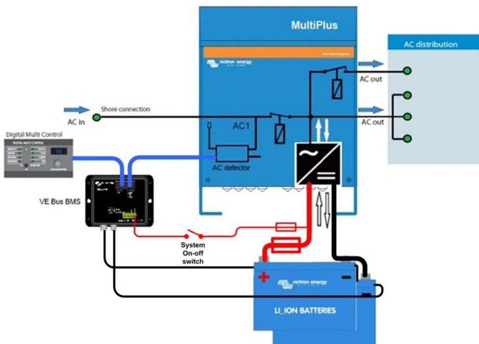
Figura 2: Diagrama de bloques con AC Detector en un MultiPlus
